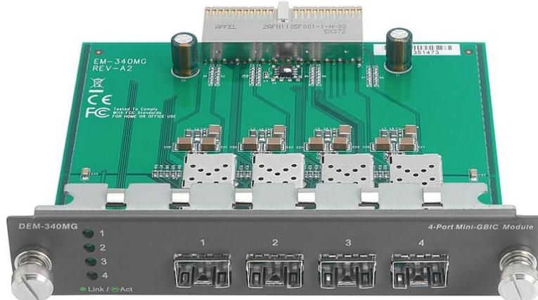
DEM-340MG - это 4-х портовый SFP модуль, разработанный для управляемого коммутатора 3-го уровня D-Link DGS-3312SR. Он имеет 4 порта SFP для подключения к серверам или корневым коммутаторам корпоративной сети.
